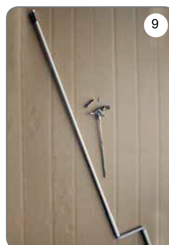
Korba, przegub Cardana 45° lub 90° z zaczepem dzwinkowym [9].
