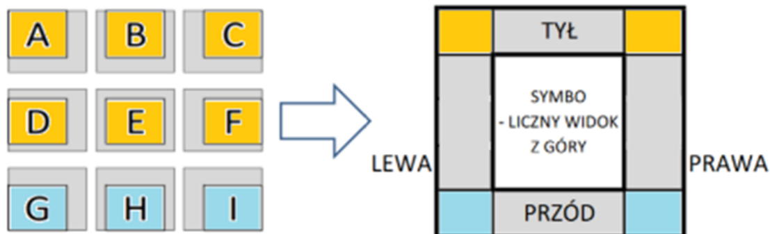
Rys. 4. Oznaczenie rodzajów stóp (widok z góry) pergoli SB500.
